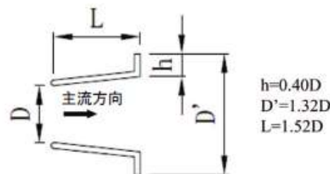
図-2 最適化したディフューザ2次元断面形状
