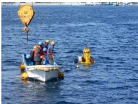
中間ブイに波浪計測機、水中カメラを搭載
